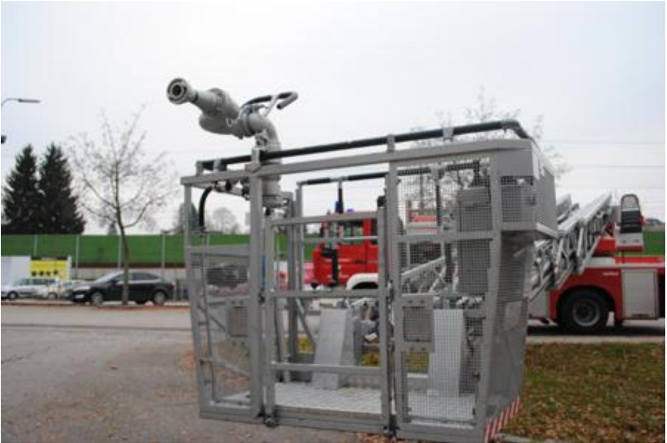
Anwendung mit Personal (nur mit Atemschutz) oder ohne Personal im Korb. Hierzu kann am Korb ein Wendestrahrohr (Monitor) 1550l/min bei 10 bar und einer Wurfweite von bis zu 50m montiert werden. Damit kann direkt von außen das Feuer bekämpft werden. Wenderohr-Einsatz nur in spannungsfrei geschalteten Anlagen oder in Absprache mit dem Betreiber.
