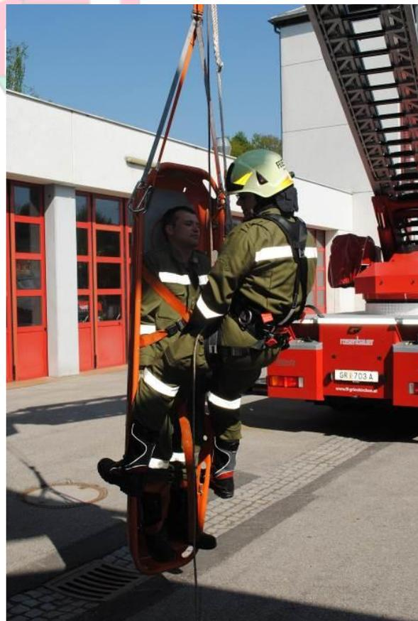
Weiteres kann die Drehleiter mittels einer unter dem Korb montierten Schleif - Korbtrage auch zur Rettung von Personen aus Baugruben oder ähnlichen Tiefen eingesetzt werden. Mittels dem mitgeführten Rollgliss Ab- und Aufseilsystem können Personen aus engen Schächten gerettet werden.
