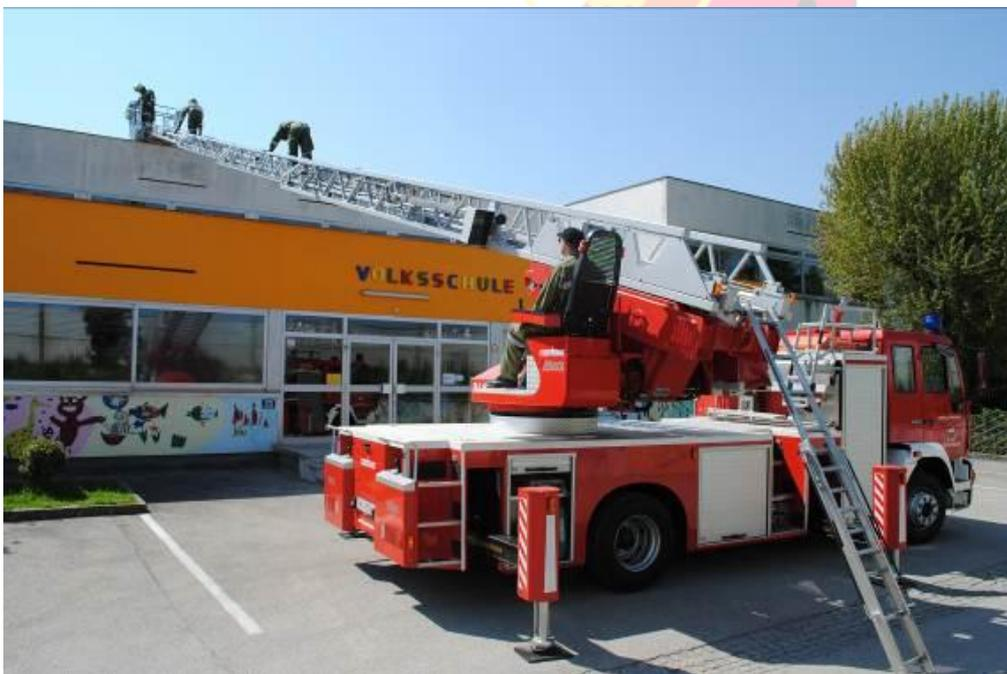
Die Drehleiter kann auch als „Rettungsbrücke“ eingesetzt werden. Dabei wird der Leiterpark oder der Korb fix am Objekt aufgelegt und es können max. 8 Personen gleichmäßig verteilt an der gesamten Leiterlänge dann zu Fuß selbständig absteigen.
