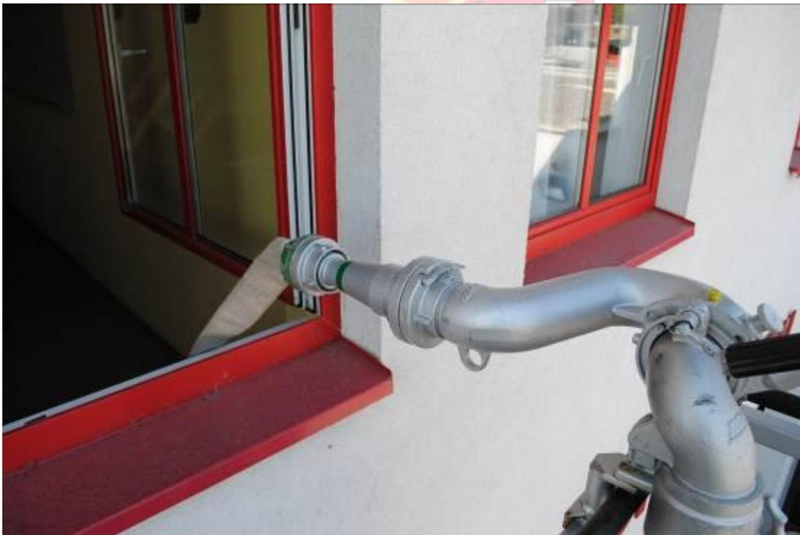
Der Angriffstrupp (mit Atemschutz) kann vom Leiterkorb aus über einen Balkon oder durch ein Fenster ins Gebäude eindringen. Über das Wendestrahrohr kann auch ein C-Hohlstrahlrohr eingesetzt werden. Auch ein Weiterführen der Angriffsleitung in das Gebäude oder auf Dächern ist möglich
