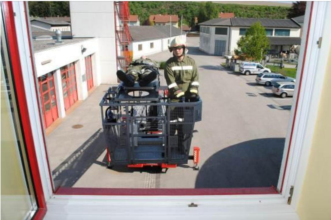
Am Leiterkorb kann eine Halterung für eine Krankentrage montiert werden. Damit ist es möglich, eine auf der Trage liegende verletzte Person schonend und liegend zu transportieren.
